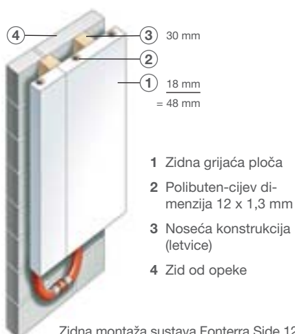
Zidna montaža sustava Fonterra Side 12
