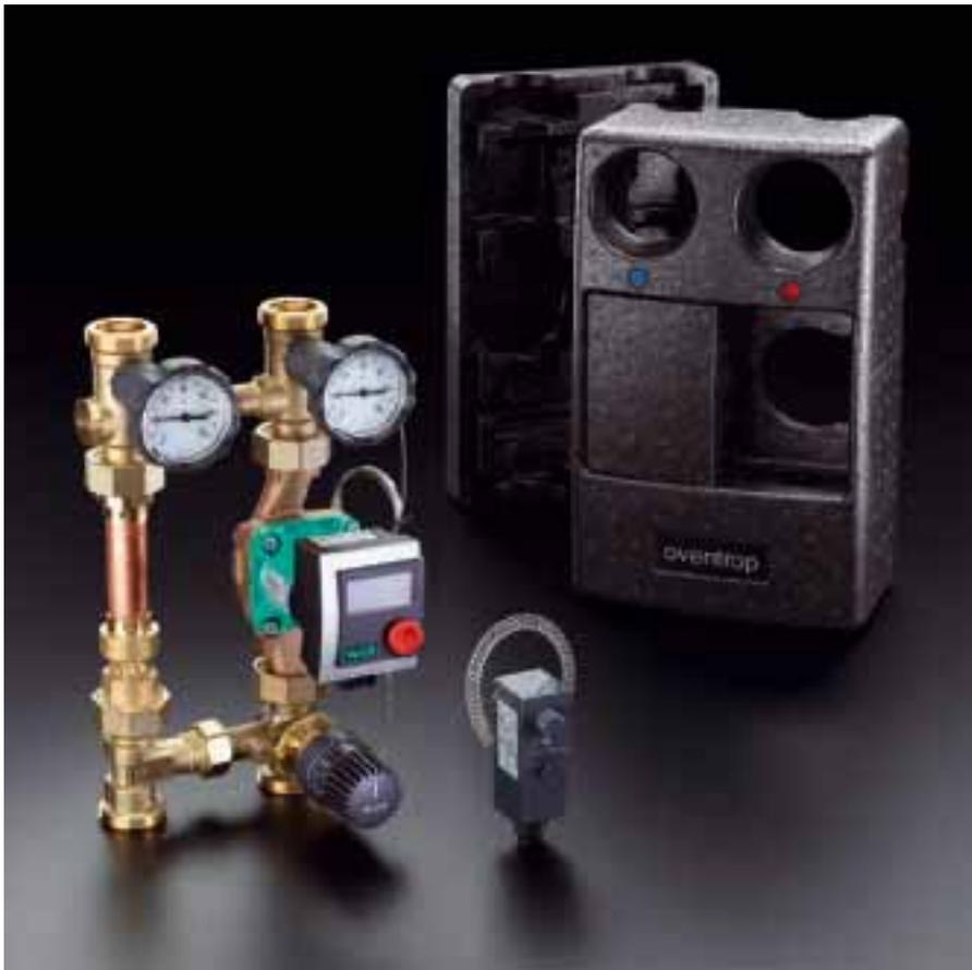
Das Festwertregel-Set „Regumat F-130/180“ ist eine Vorlauftemperaturregelung und Begrenzung für kombinierte Radiator-Fußbodenheizungen. Die Vorlauftemperatur wird in einem Einstellbereich von 20–50 °C geregelt. Die Ausführung „Regumat FR-180“ besitzt ein Pumpengehäuse aus Rotguss, um der Korrosionsgefahr bei systembedingtem Sauerstoffeintrag entgegenzuwirken.
