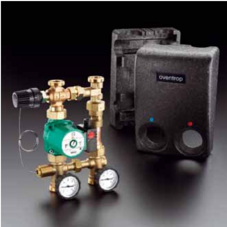
Das Kessel-Anbindesystem „Regumat RTA“ ermöglicht den Anschluss des Heizsystem/ Speichers an den Holz-Heizkessel. Die Rücklaufftemperatur zum Holz-Heizkessel liegt min. bei 55 °C und somit oberhalb des Taupunktes. Sie verhindert die Kondensat-Teerbildung. Im Anfahrbetrieb läuft der Kesselkreis im Kurzschluss, über den Bypass wird dem Rücklauf heißes Vorlaufwasser zugeführt. Nach Erreichen der Rücklaufftemperatur von 55 °C öffnet das Mischventil.
