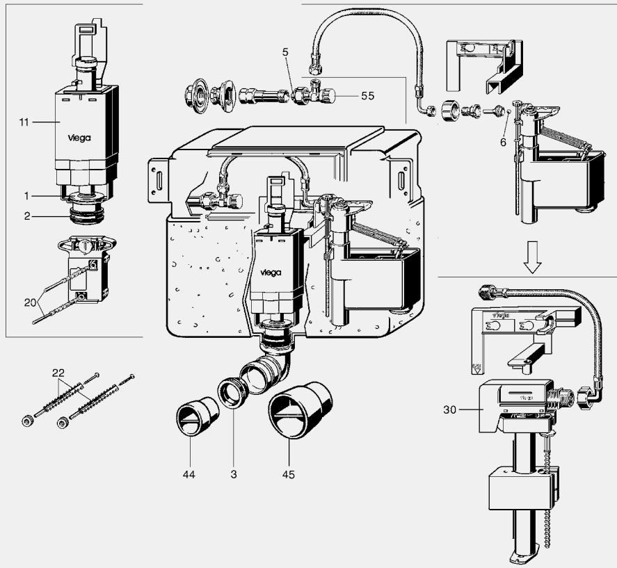
podometni splakovalnik 2L za aktivirne tipke Visign, v izvedbi za nizko višino vgradnje, sprožanje od zgoraj, od serije 2007 do 2014, uporaba pri izdelkih:
