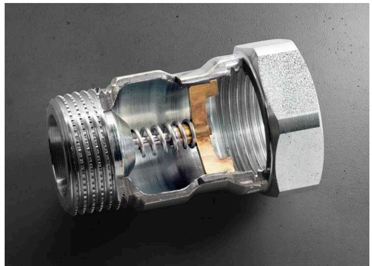
Bei einer Erwärmung oberhalb einer Temperatur von 95 °C schmilzt das Lot, die Feder löst sich und das Ventil wird dauerhaft metallisch dichtend verschlossen. Nach Auslösen der Absperrrichtung muss die TAE ausgetauscht werden.
