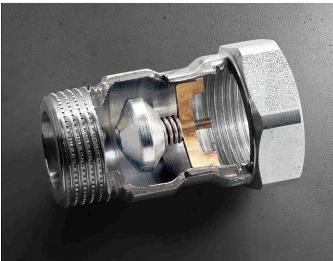
Die Thermisch auslösende Absperrrichtung besitzt einen Dichtkegel, der mithilfe eines Schmelzlots und einer Feder in seiner Position gehalten wird.
