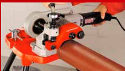
Uporaba orodjem za valjanje utorov ROGROOVER
