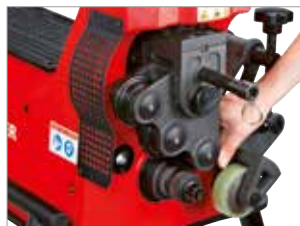
3-krat nastavitve velikosti tlaka valjev brez orodja
